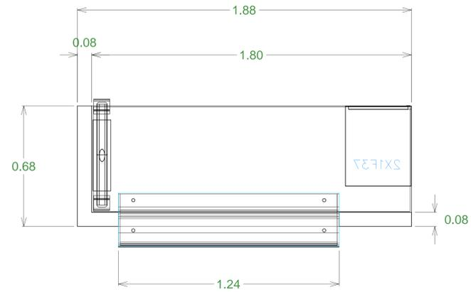
Mostrador en vidrio templado 10 mm pulido y brillante con perforaciones para dilatador en aluminio
